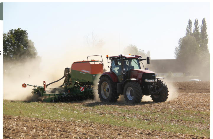
Le nouveau semoir pneumatique Centaya 3000, dispose du nouvel élément semeur Amazone « TwinTec » avec double disques et roues plombées. ©DR
